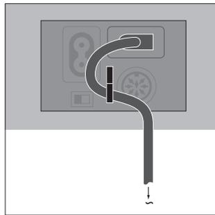
**Kabelklemme:** Aus Sicherheitsgründen muss das mit der Netzdose verbundene Netzkabel am Lautsprecher befestigt werden. Ziehen Sie das Kabel hierzu hinter die Klemme.
