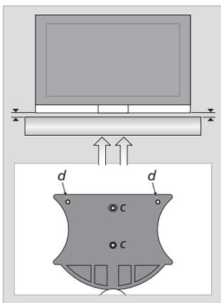
**Einstellungen:** Achten Sie zuerst darauf, dass das TV-Gerät auf seinem Stand bzw. seiner Wandhalterung eben ausgerichtet ist. Justieren Sie den Lautsprecher dann mit den beiden Schrauben (d) so, dass er parallel zur Unterkante des TV-Geräts steht. Richten Sie die Lautsprecherfront zum TV-Gerät aus und ziehen Sie die beiden Schrauben (c) fest.
